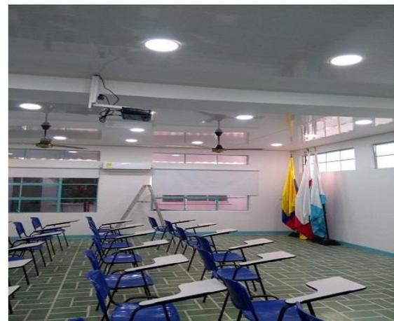
Cielo raso en PVC, ventilador de techo KDK y balas tipo LED.
